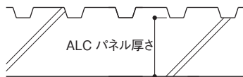
解説図-3 外壁用意匠パネルの最大支点間距離算定用のALCパネル厚さ(断面図)
