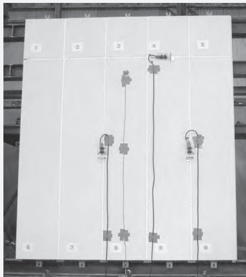
SDR低層ロックン構法の面内変形試験 試験機関: (財)建材試験センター
